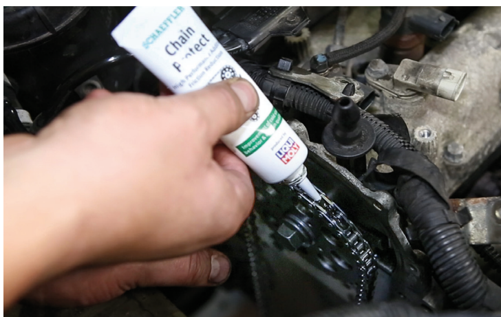
Fig. 2: Schaeffler Chain Protect se aplica en todos los componentes durante el montaje de la cadena en el sistema de distribución.
