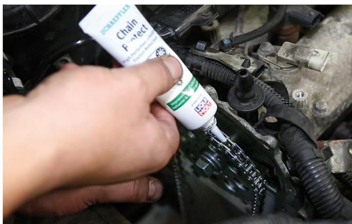
Figura 2: Schaeffler Chain Protect viene applicato durante il montaggio della catena su tutti i componenti della distribuzione.
