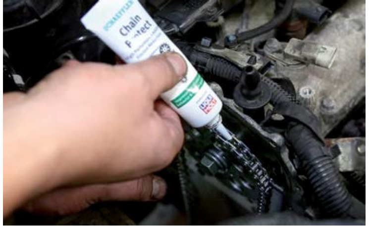
Resim 2: Schaeffler Chain Protect, zincir takılması sırasında tüm zamanlama zinciri sistemleri bileşenlerine uygulanabilir
