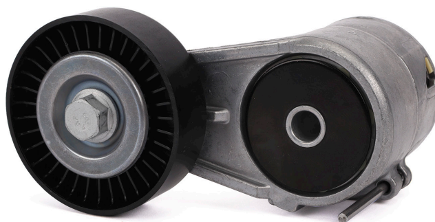
Obrázek 1: Příklad starého provedení s montážním kolíkem
