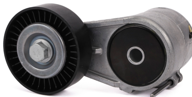
Image 1 : Exemple d'une ancienne version avec goupille de montage
