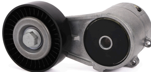
Afbeelding 2: Voorbeeld van een nieuwe uitvoering zonder montagepin
