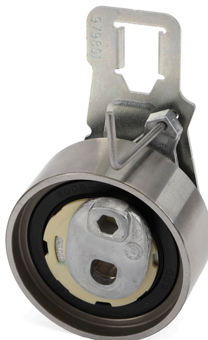
Obrázek 2: Nové provedení s ocelovou oběžnou dosedací plochou
