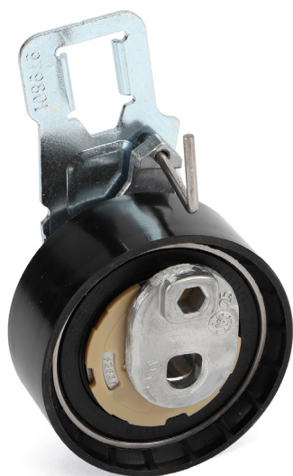
Bild 1: Tidigare utförande med mantelyta i plast.
