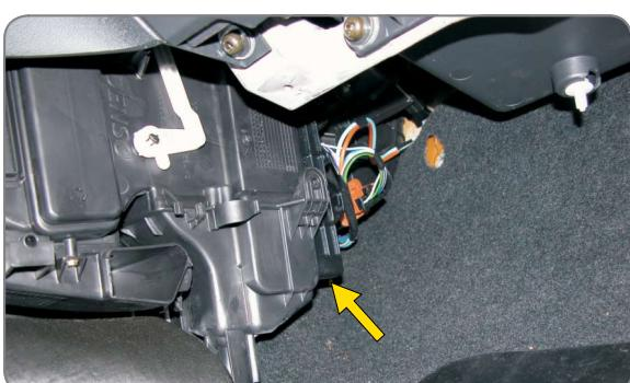
**PL** Odkręcić wkręt pokrywy filtra, usunąć pokrywę
