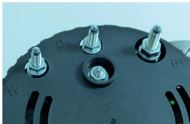
Figura 2: Denominación de los terminales en el alternador: W = señal de velocidad, D+ = indicador de carga y B+ = positivo de batería
