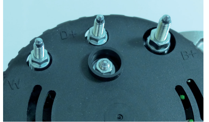
Resim 2: Alternatör üzerindeki terminal adları: W = Devir sayısı sinyali, D+ = Şarj kontrol lambası ve B+ = Akünün artı kutbu
