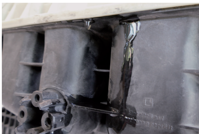
Εικόνα 3: Το υπερβάλλον ψυκτικό εξέρχεται ξανά στην περιοχή του διαχωριστικού αρμού στο δοχείο διαστολής
