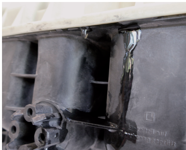
Рисунок 3: Выход излишней охлаждающей жидкости около соединительного шва на расширительном баке
