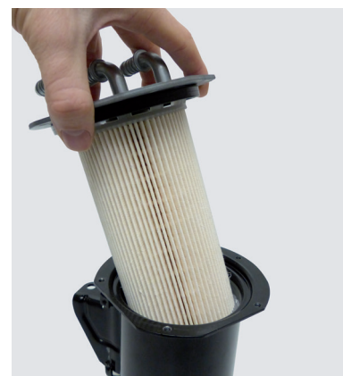
Εικόνα 3: Ανάλογα με τον τύπο κατασκευής, το φίλτρο θα πρέπει να στερεωθεί πρώτα στο καπάκι του περιβλήματος.
