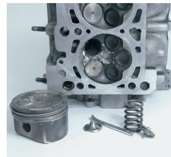
Εικόνα 5: Τυπική εικόνα βλάβης μετά το σπάσιμο μίας βαλβίδας
