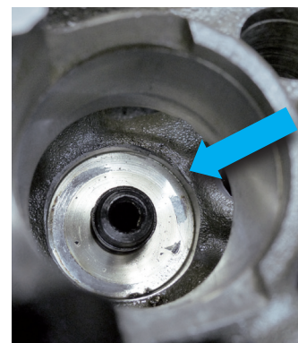
Εικόνα 3: Σημάδια πίεσης στην κυλινδροκεφαλή
