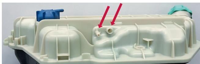
Рисунок 2: Расширительный бачок нового поколения с двумя разъемами
