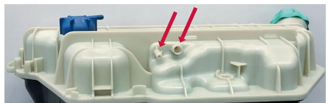
Abbildung 2: Ausgleichsbehälter der neuen Generation mit zwei Anschlüssen
