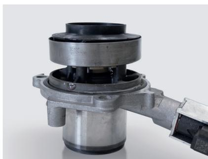
Abbildung 1: Geregelte Kühlmittelpumpe mit festsitzender Schieberblende (keine Zirkulation)
