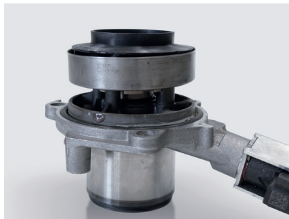
Рисунок 1: Регулируемый насос охлаждающей жидкости с заблокированной заслонкой (циркуляция охлаждающей жидкости невозможна)
