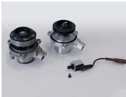
Рисунок 2: Исполнительный механизм регулируемого насоса следует смонтировать на новом насосе
