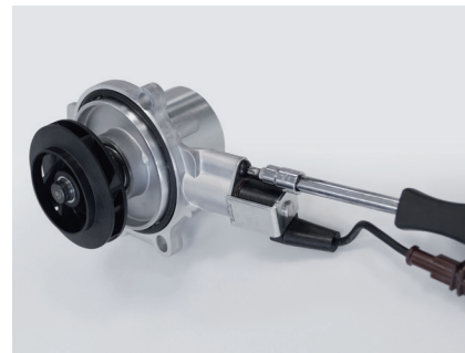
Рисунок 3: Новый нерегулируемый насос охлаждающей жидкости со смонтированным исполнительным механизмом от старого насоса
