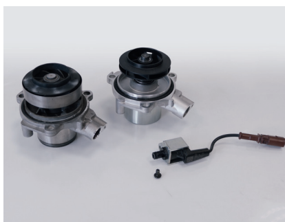
Figura 2: El actuador de la bomba regulada debe desmontarse y montarse en la nueva bomba
