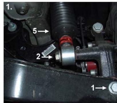
**Achtung:** Die Federkraft wirkt auf den Querlenker. Durch Absenken des Querlenkers Original-Feder entspannen und diese entnehmen.
