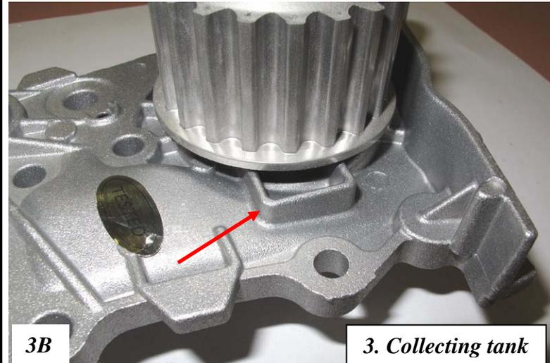
**Fig.3A-3B:** La vecchia versione aveva solo il foro di drenaggio posizionato sotto la puleggia che scaricava eventuali perdite di assestamento direttamente sul corpo pompa, mentre nel corpo pompa della nuova versione è stato integrato un piccolo serbatoio di raccolta atto a contenere eventuali piccole perdite temporanee che possono manifestarsi durante la fase di assestamento delle superfici di scivolo della tenuta meccanica.
