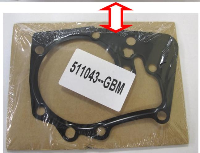
**Fig.1A-1B:** nella vecchia versione, il piano di fissaggio presenta delle scanalature per l'applicazione della pasta sigillante, in fatti, la vecchia versione della PA 24-1043 non era fornita con guarnizione e la pompa acqua si doveva montare con pasta sigillante. La nuova versione invece ha il piano di fissaggio completamente liscio perché fornita con guarnizione.
