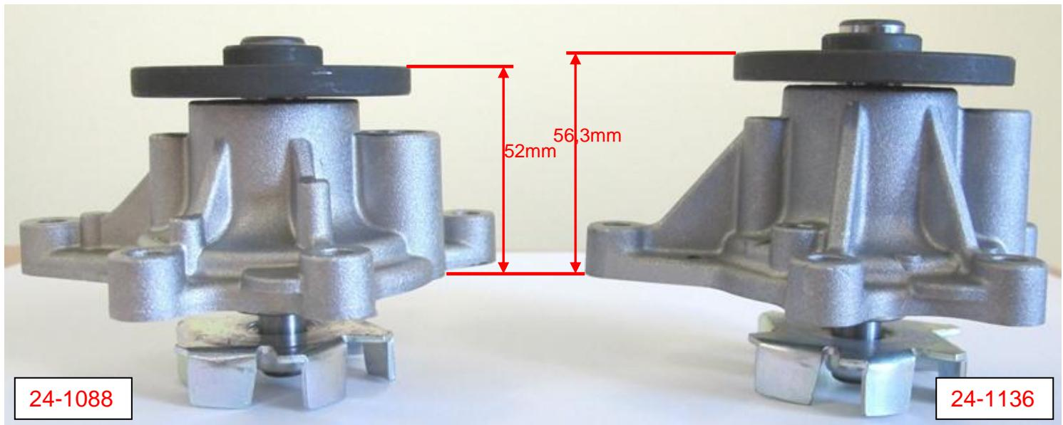
1. Il corpo della pompa acqua 24-1136 è più alto rispetto al corpo della pompa acqua 24-1088
