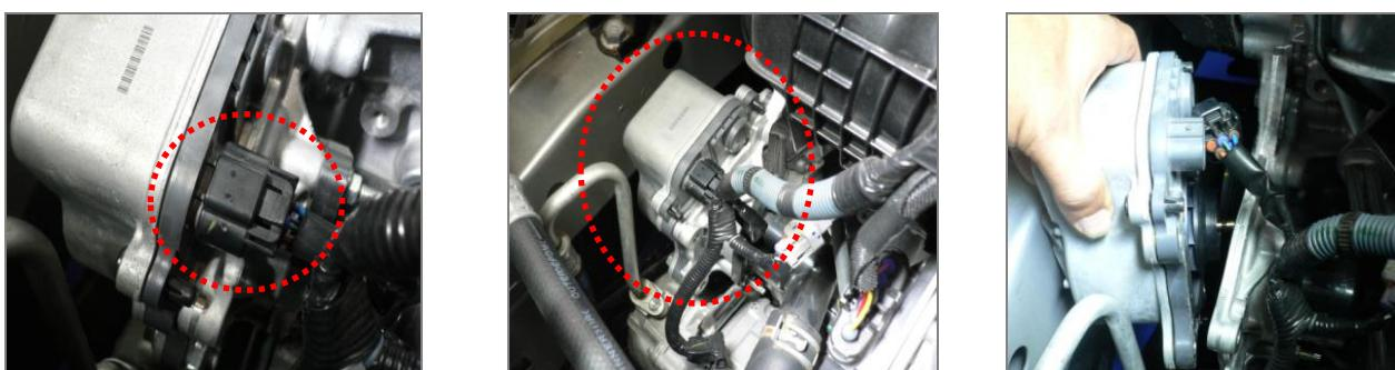
7. Zamontuj nową pompę wodną, wsuń łącznik, aż rozlegnie się kliknięcie i zamontuj filtr powietrza.
