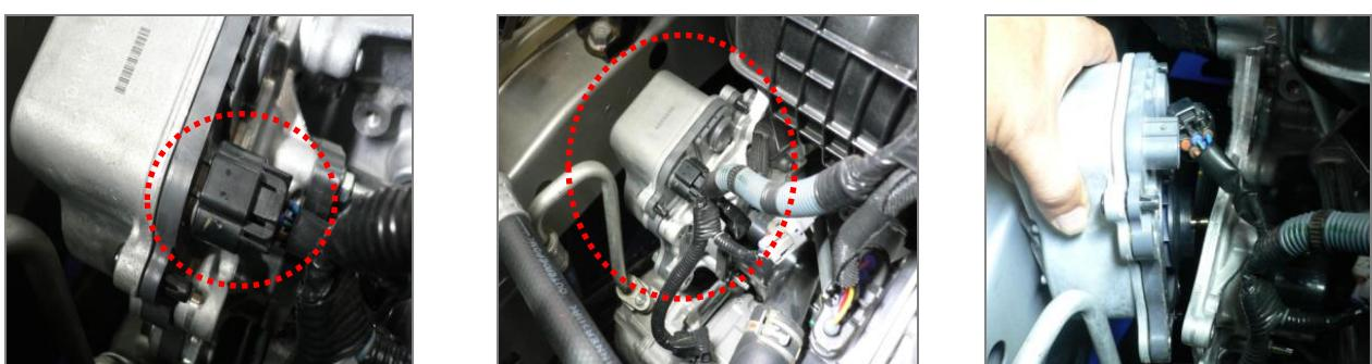
7. Τοποθετήστε τη νέα αντλία νερού, εισάγετε το βύσμα έως ότου ακουστεί ένα «κλικ», και τοποθετήστε το φίλτρο αέρα.
