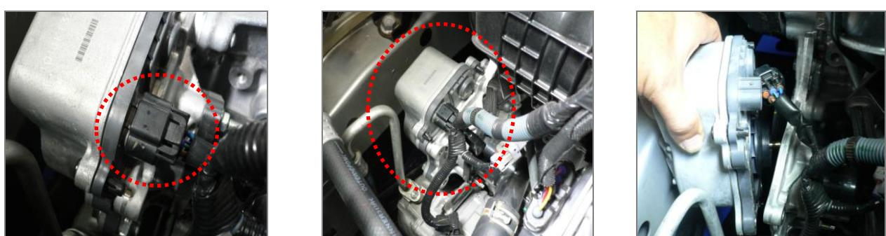
7.Installare la nuova pompa dell' acqua, inserire il connettore fino allo scatto e installare il filtro dell' aria.
