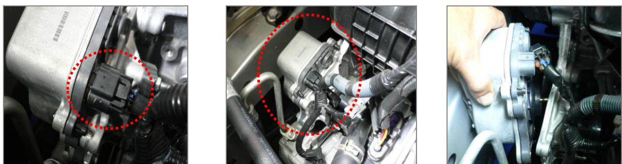
7. Instale a nova bomba de água, insira o conector até encaixar com um estalido e instale o filtro de ar.
