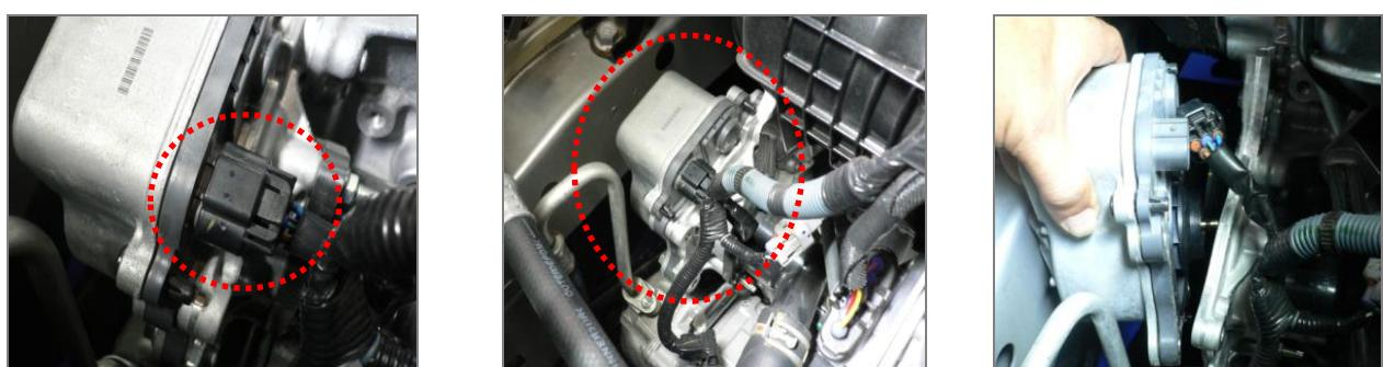
7. Instale la bomba de agua nueva, inserte el conector hasta que haga clic, e instale el depurador de aire.
