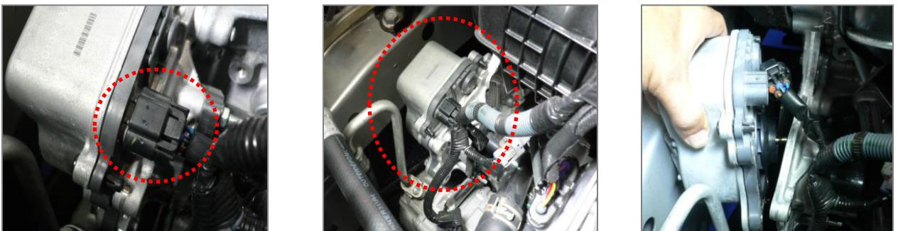
7. Bauen Sie die neue Wasserpumpe ein, führen Sie den Steckverbinder ein, bis er klickt, und setzen Sie den Luftfilter ein.
