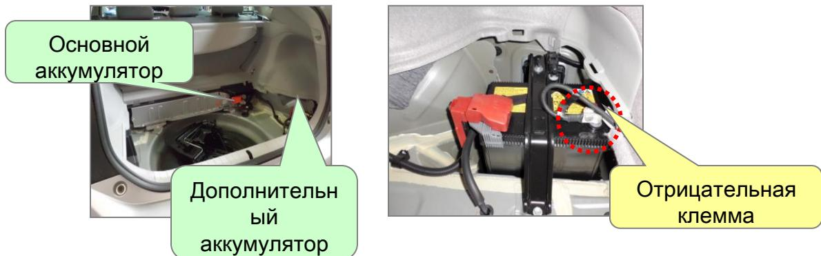
2. Снимите заглушку сервисного разъёма с основного аккумулятора.
