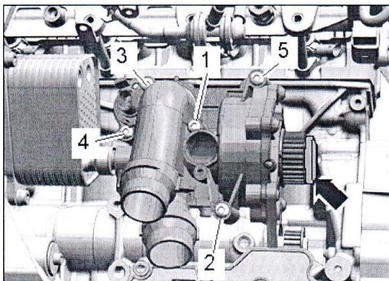
Tightening screws/serraggio viti: **9Nm**
