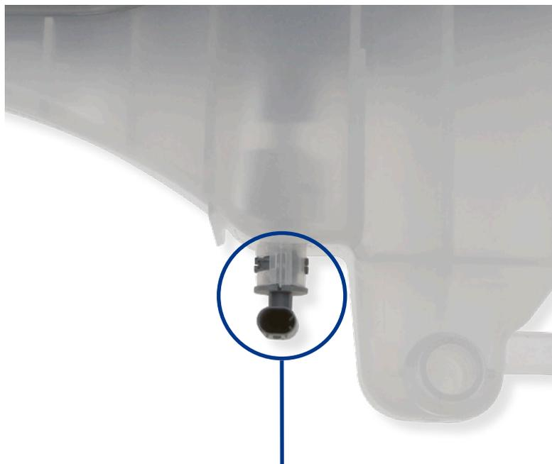
После замены расширительного бачка, наполните его охлаждающей жидкостью выбранной в соответствии с рекомендациями автопроизводителя и проверьте нет ли течей в местах крепления патрубков, убедитесь, что датчик уровня подсоединен. После установки проверьте нет ли течей в шлангах системы охлаждения.
