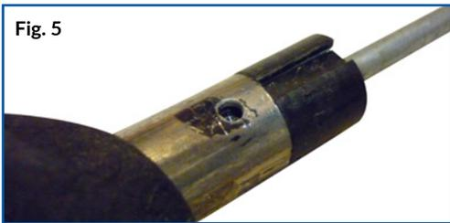
broca de 2,5>3,0 mm. Una vez taladradas, gire y tire cuidadosamente del manguito de plástico y extráigalo con suavidad del tubo metálico. (Figuras 4 y 5)
