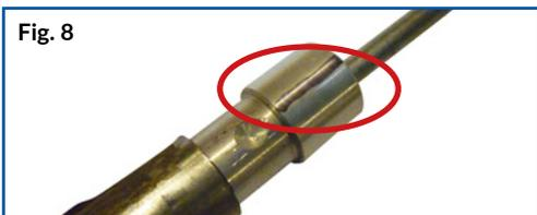
**Nota:** El nuevo manguito se debe instalar a 90 grados respecto al manguito de plástico original de forma que las pequeñas hendiduras del manguito de aluminio no estén alineadas con los agujeros taladrados en el tubo. Le recomendamos que haga unas marcas de alineación en el manguito y el tubo para facilitar el siguiente paso. (Figura 8)
