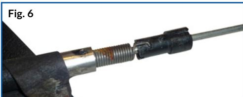
**Nota:** No tire directamente del manguito de plástico sin taladrar las hendiduras ya que el tubo podría resultar dañado. Asimismo, antes de instalar el manguito nuevo, quizás deba limar el interior del tubo metálico para eliminar las virutas generadas al taladrar.
