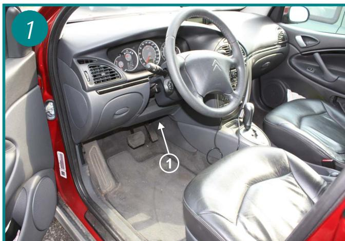
Le filtre habitacle est situé à l'intérieur du véhicule, côté conducteur, au niveau du pédalier (1).
