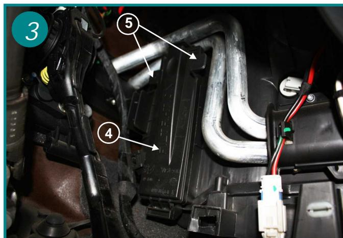
Ouvrir le boîtier filtrant (4) en agissant sur les poignées (5), le couvercle est articulé dans sa partie inférieure
