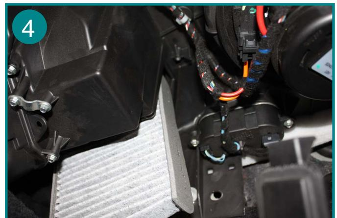
Extraire les 2 éléments filtrants usagés (placés l'un à côté de l'autre) et les remplacer. Le remontage s'effectue dans l'ordre inverse du démontage.
