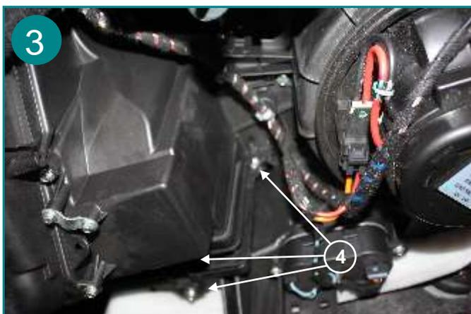
Dévisser ensuite les 3 vis de fixation du couvercle du boîtier filtrant (4).
