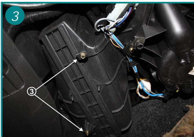
Dévisser les 2 vis de 6 sur le couvercle du boîtier (3). Retirer ce couvercle.
