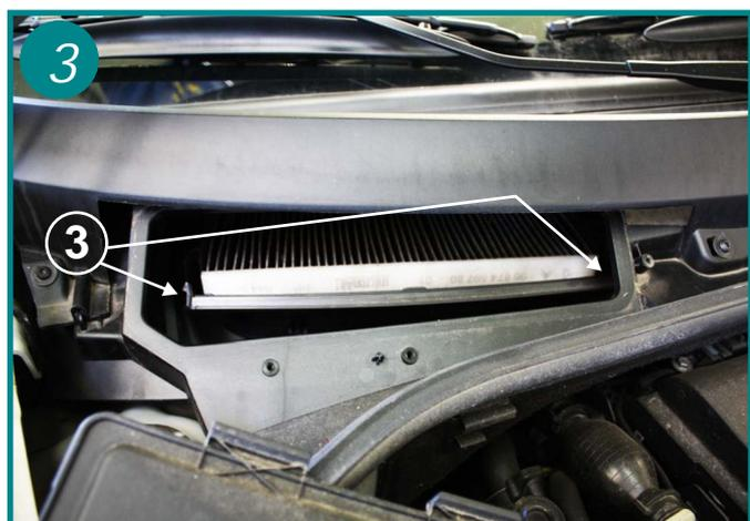
Appuyez sur les loquets de fermeture du boîtier filtrant (3), et basculer le volet.
