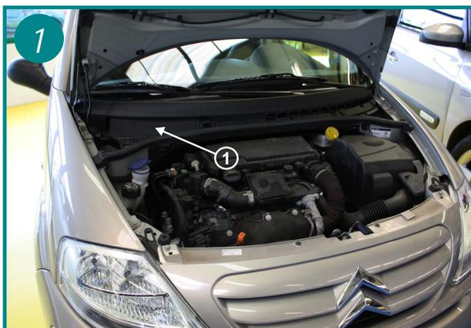
L'élément filtrant est situé coté passager sous le capot moteur sur la baie du pare brise
