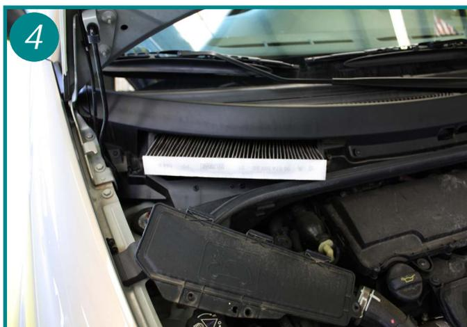
Sortir l'élément filtrant de son boîtier et le remplacer. Le remontage s'effectue dans l'ordre inverse du démontage.
