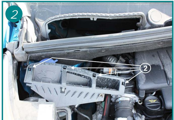
Basculer les 4 loquets d'ouverture (2) de la trappe, retirer celle-ci.
