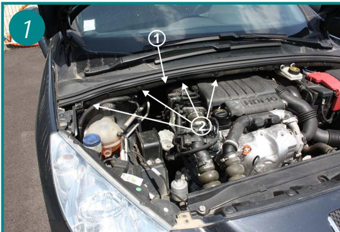
Le filtre d'habitacle est situé sous le capot moteur, côté passager, sous la baie de pare-brise (1). Retirer les 4 clips plastiques (2)
