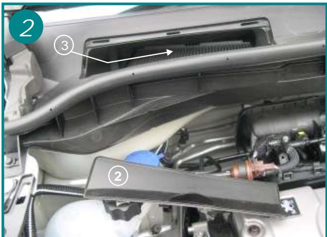
Retirer la trappe (2), le filtre à particule est alors visible dans son boîtier plastique (flèche 3)
