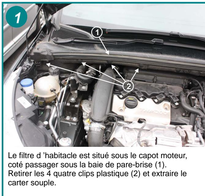
Le filtre d 'habitacle est situé sous le capot moteur, coté passager sous la baie de pare-brise (1). Retirer les 4 quatre clips plastique (2) et extraire le carter souple.
