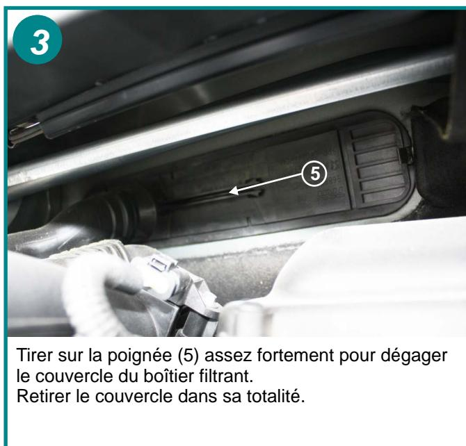
Tirer sur la poignée (5) assez fortement pour dégager le couvercle du boîtier filtrant. Retirer le couvercle dans sa totalité.
