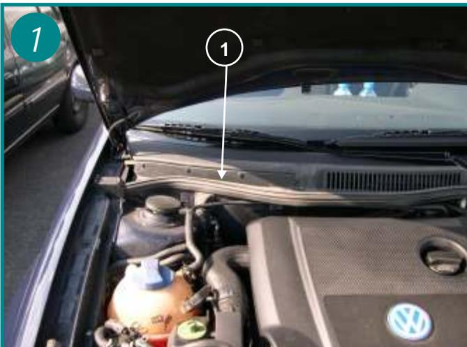
Le filtre d'habitacle est situé sous la baie de pare-brise, coté passager sous le capot moteur (repère 1). Ouvrir le capot moteur.
