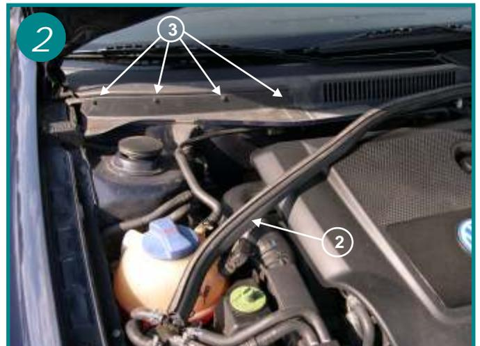
Retirer sur la moitié, le joint d'étanchéité moteur (repère 2)
