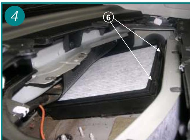
Dégager l'élément filtrant de son cadre en actionnant les 2 pattes de fixation (flèche 6) et le remplacer.
