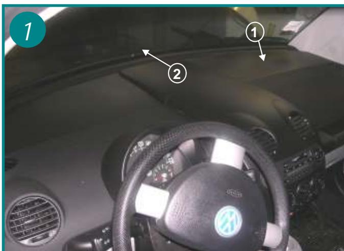
Le filtre à air d'habitacle est situé à l'intérieur du véhicule sur la planche de bord coté passager. (voir flèche 1)
