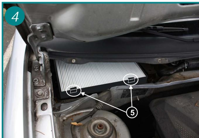
Basculer vers l'extérieur les 2 petites pattes (5) de maintien et procéder au remplacement du filtre. Le remontage s'effectue dans l'ordre inverse du démontage.
