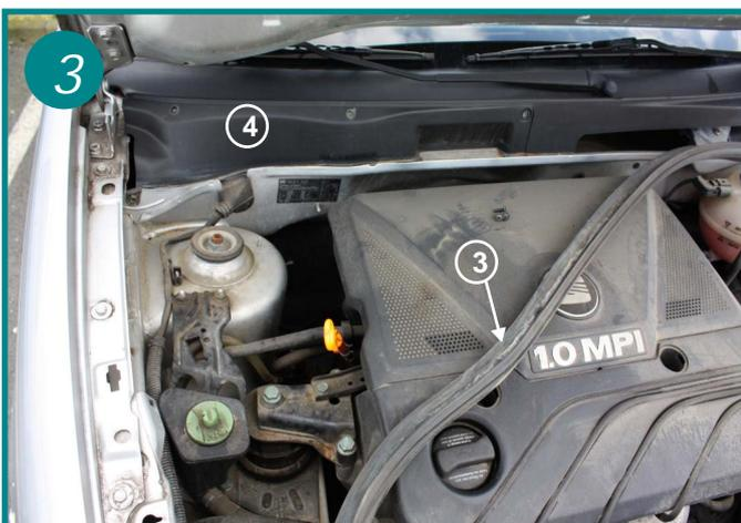
Retirer sur la moitié, le joint d'étanchéité du capot moteur (3) et extraire le carter (4) dans sa totalité.
