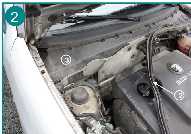
Retirer sur la moitié le joint d'étanchéité du compartiment moteur (2).
