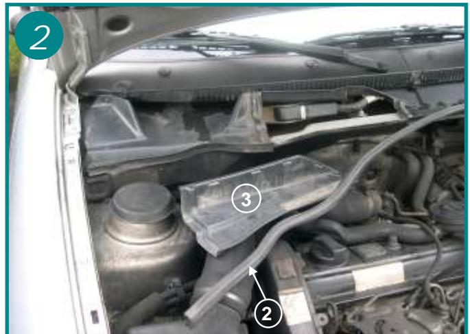
2 Retirer le joint d'étanchéité du compartiment moteur (2) retirer également le cache d'accès au moteur d'essuie glace (3)
