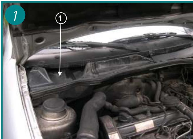
1 L'élément filtrant est situé sous le capot moteur côté passager sous la baie de pare brise (voir flèche 1)
