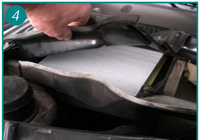
4 Retirer l'élément filtrant usagé et le remplacer. Le remontage s'effectue dans l'ordre inverse du démontage
