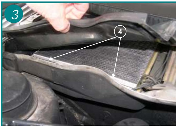
3 Soulever le cache protégeant le filtre (il n'est pas nécessaire de le retirer totalement). Décliper les 2 pattes de fixation du filtre sur son boîtier (flèche 4)
