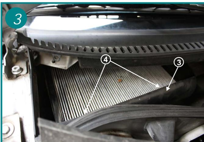
Retirer ensuite le déflecteur (3) pour avoir accès aux 2 fermetures, agir sur ceux-ci pour dégager le filtre et son cadre. Les 2 fermetures sont situés au niveau des flèches (4).
