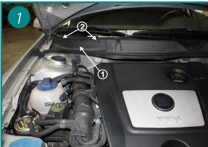
Le filtre d'habitacle est situé sous le capot moteur, côté passager sous la baie de pare-brise (1). Dévisser les 2 clips plastiques (2).
