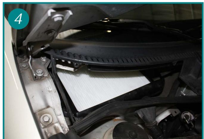
Replacer le filtre neuf dans son cadre, imbriquer les 2 premiers plis dans les nervures prévues à cet effet. Le remontage s'effectue dans l'ordre inverse du démontage.
