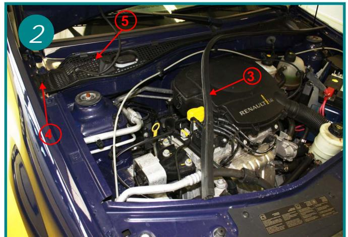
Retirer le joint d'étanchéité du compartiment moteur (3), puis le rivet plastique (4) pour extraire le cache grillagé (5) sur la moitié.
