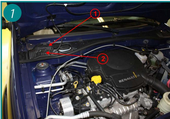
Le filtre d'habitacle est situé sous le capot moteur, sous la baie de pare-brise coté passager (1). Ouvrir le capot moteur et détacher le conduit d'alimentation du lave glace (2).
