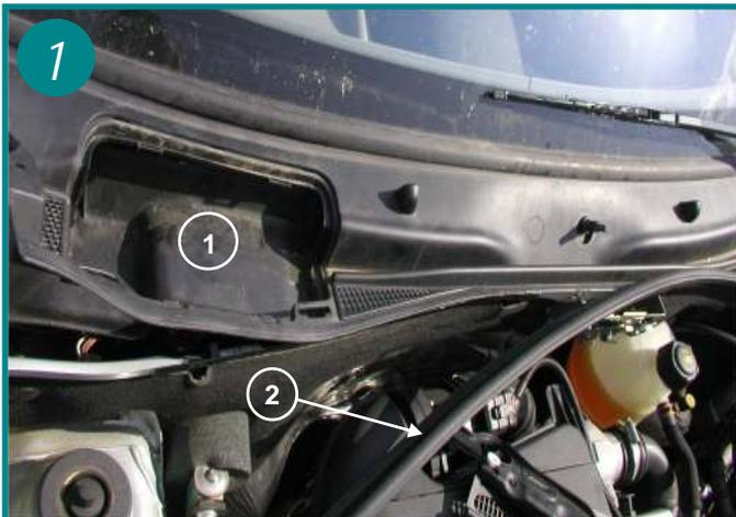
L'élément filtrant est situé sous la baie de pare brise coté passager . Ouvrir le capot moteur.
