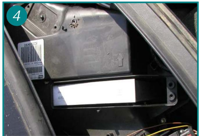
Extraire l'élément filtrant en le tirant vers le haut. Remplacer l'élément filtrant usagé par un nouvel élément. Le remontage s'effectue dans l'ordre inverse du démontage.
