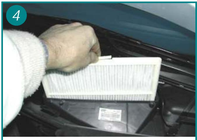
Extraire l'élément filtrant usagé en le tirant vers soi. Engager le nouvel élément dans les glissières. Le remontage s'effectue dans l'ordre inverse du démontage.
