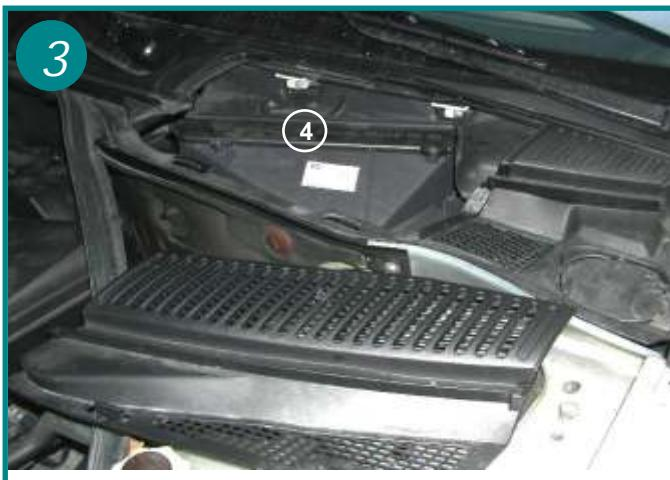
Retirer le couvercle du climatiseur maintenu par 2 vis (4).
