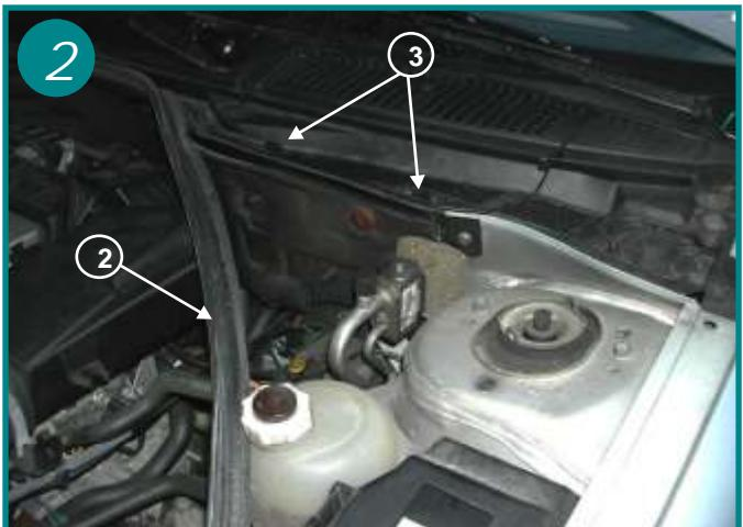
Retirer sur la moitié le joint d'étanchéité du compartiment moteur (2) pour dégager le couvercle de la grille d'aération. Retirer cette grille en dégageant les 2 clips (flèche 3).
