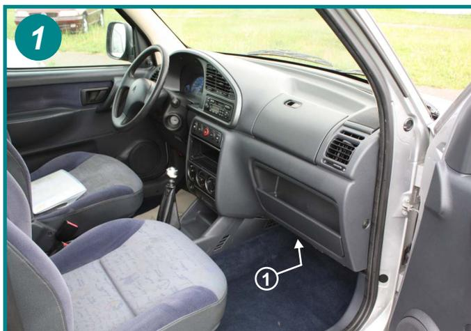
Le filtre d'habitacle est situé à l'intérieur du véhicule, côté passager sous la boîte à gants (1). Ouvrir la porte côté passager.
