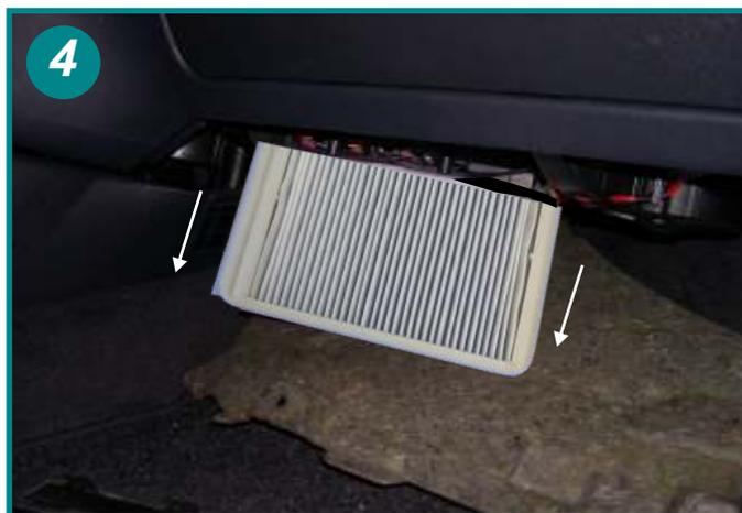
Extraire l'élément filtrant usagé en le tirant vers le bas. Le remontage s'effectue dans l'ordre inverse du démontage.
