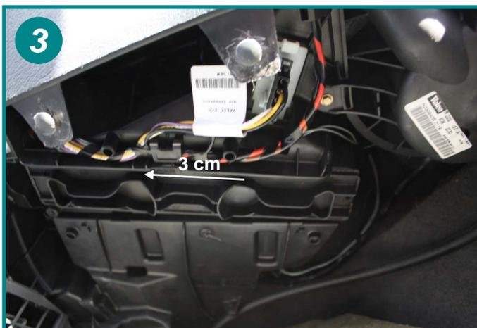
Faire coulisser d'environ 3 cm la trappe d'entrée du boîtier filtrant (voir flèche) et retirer le couvercle.
