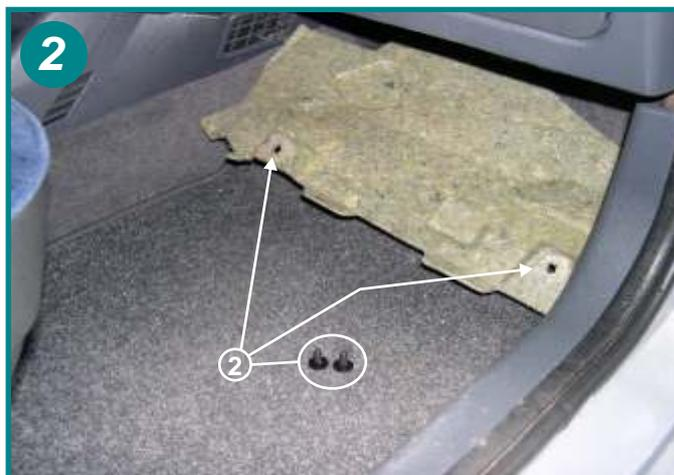
Retirer les 2 goupilles plastiques (2) et abaisser le cache sous la boîte à gants, il n'est pas nécessaire de le retirer totalement.
