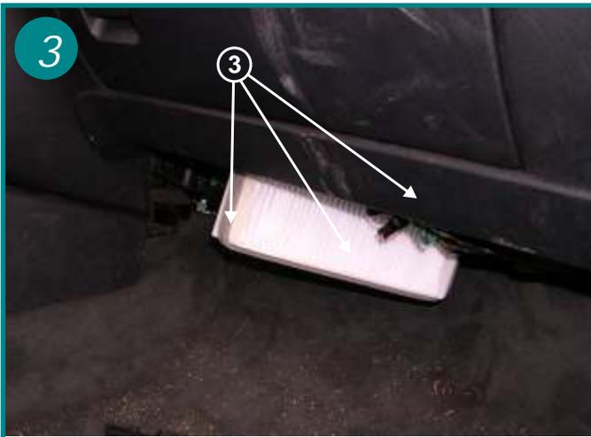
Dévisser les 3 vis cruciformes situées sur le boîtier du climatiseur et retirer le couvercle ( flèche 3)
