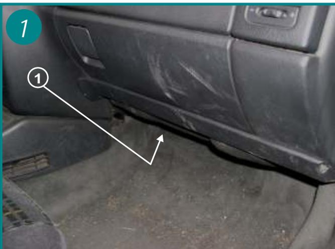
L'élément filtrant est situé dans l'habitacle du véhicule sous la boîte à gants (voir flèche 1). Ouvrir la porte coté passager.
