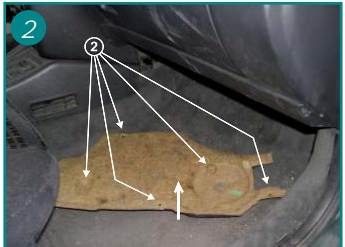
Retirer le cache sous la boîte à gants maintenu par 5 vis Torx (voir flèche 2).
