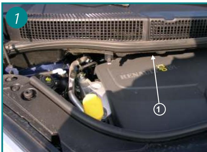
L'élément filtrant est situé sous le capot moteur au centre sous la baie du pare brise (Voir flèche 1). Ouvrir le capot moteur.
