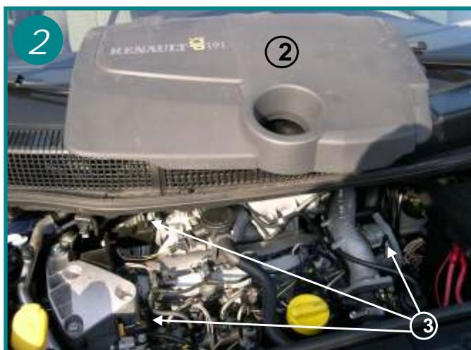
Retirer le résonateur qui couvre le moteur en tirant dessus. Ce résonateur (2) est maintenue en place à l'aide de trois rotules (flèches 3).
