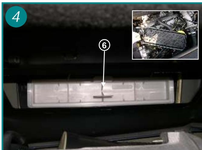
Extraire l'élément filtrant en le tirant par sa poignée (6). Le remontage s'effectue dans l'ordre inverse du démontage.
