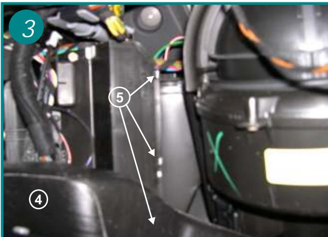
Ouvrir le boîtier filtrant après avoir retiré les 3 clips de fermeture (voir flèche 5).
