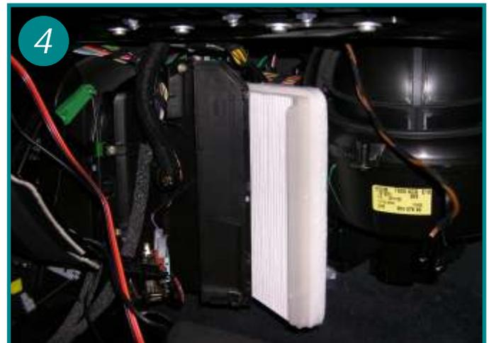
Extraire l'élément filtrant usagé, placer le nouvel élément filtrant dans ces rainures en évitant d'abîmer le joint en mousse autour de l'élément. Le remontage s'effectue alors dans l'ordre inverse du démontage
