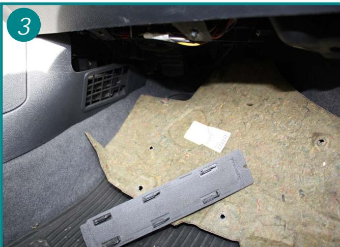
Il n'est pas nécessaire de retirer totalement le carter souple sous la boîte à gants.
