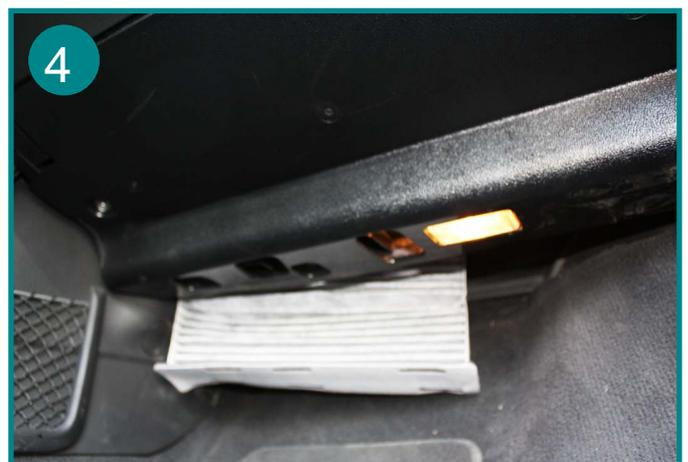
Extraire le filtre usagé par le bas et le remplacer. Le remontage s'effectue dans l'ordre inverse du démontage.
